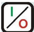
Tecla de início de processo e/ou parada para interrupção do processo de centrifugação.
